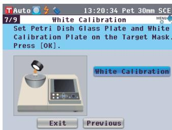
8. 将培养皿测量套件（可选配件）中包含的培养皿用校正玻璃和白色校正板正确安装到目标罩上。
