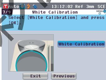
13. 确认光标在“White Calibration” (白板校正) 上，然后按下 [OK/Edit] (确定/编辑) 按钮。
