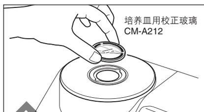
3. 将零位校正盒对准培养皿用目标罩上的定位凹槽，然后将其推入。
