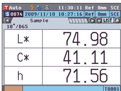
7. 按照测量类型, 将样品放在目标罩上或透射样品腔中, 然后按下 [MEAS](测量)按钮。
