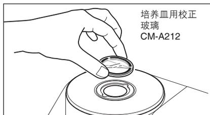
3. 将白色校正板对准培养皿用目标罩上的定位凹槽，然后将其推入。
