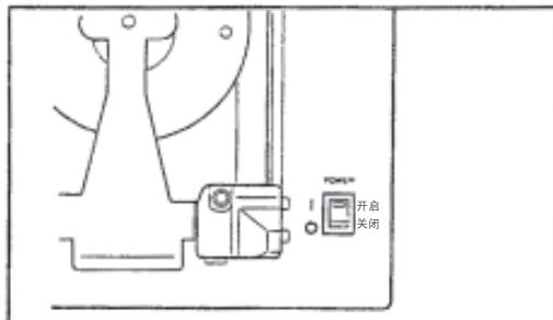
2 将 AC 适配器的输出插头插入分光测色计后侧的 AC 适配器输入插座。
