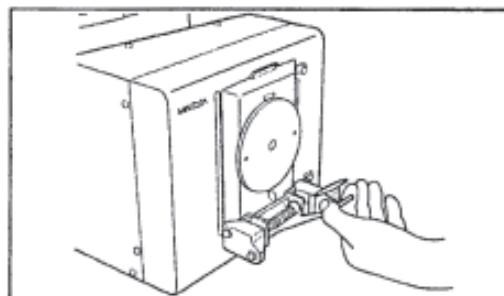
2 将校零盒的突起部分与分光测色计的测量端口底板的凹口对齐，并使样品固定器紧贴校零盒。
