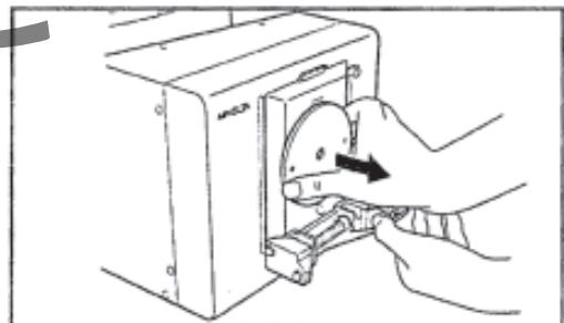
3 使将要安装的目标罩定位孔与分光测色计的样品测量端口底板的目标罩定位管脚对齐，并将目标罩滑到样品测量端口底板前。
