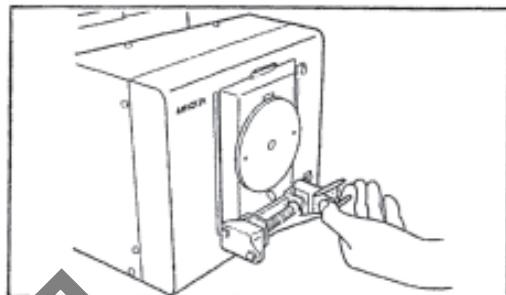
2 将样品固定器臂上的圆形板与白色校正板后侧的圆形凹口对齐，并使样品固定器紧贴白色校正板。
