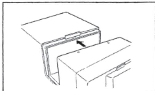
2 将样品（或装有液体样品的容器）平放在照明口前。
